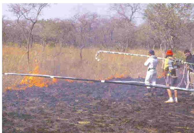
Рис. 2.3.6. Анализ состава газовыделений от пожаров, исследуемых в организации SAFARI с использованием пробоотборников
